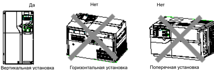
Рис 4.1 Установка ПЧ
