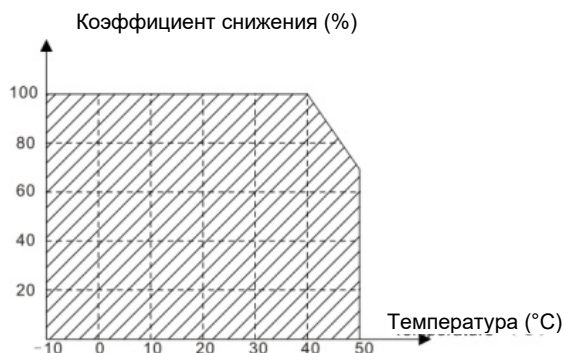
Рисунок 3-2. Снижение номинальной мощности преобразователя частоты СМ4 в зависимости от температуры окружающей среды.
